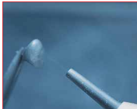
удаление оксида в пескоструйке
